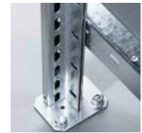
Bodenbefestigung für Regale mit dem Höhen-/Tiefenverhältnis \geq 5:1 . Diese Regale müssen gegen Kippen gesichert werden (Wand- oder Fußverankerung).
